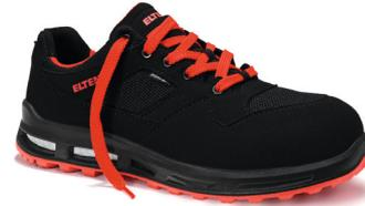
Mikrofaser/Meshmaterial; Atmungsaktives Textilfutter; Gepolsterte Lasche; Kunststoffkappe; Ganzflächige Einlegesohle ESD PRO black mit Anteilen aus recycelten Materialien; Metallfreier Durchtrittschutz; PU/PU Sohle WELLMAXX TRAINERS; Metall- und lederfreie Ausstattung, Sohlenkern aus Infinergy® von BASF, Extra Senkel beiliegend
